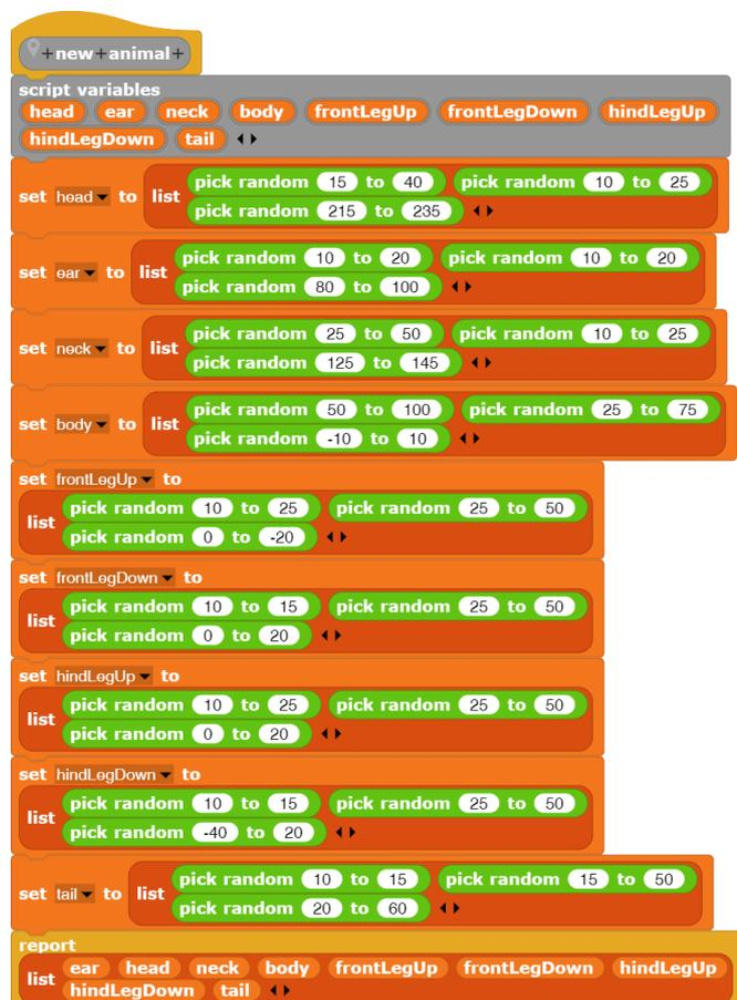
Neue Tiere können von dem Objekt *Animal* erzeugt werden, das hat dafür eine lokale Methode. In dieser werden die Teile des Tiers als Listen von „halbwegs brauchbaren“ Zufallszahlen erzeugt. Danach werden sie zu einer Gesamtliste zusammengesetzt.
