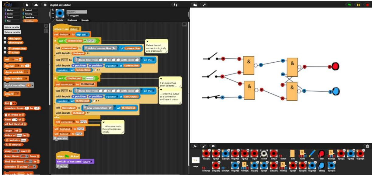
Ein *Digitalsimulator* ist ein Programm, mit dem sich digitale Schaltungen simulieren lassen. Es besteht aus Schaltern, LEDs und Gattern, in diesem Fall nur aus NANDs (Not AND), aus denen sich alle anderen Schaltungen aufbauen lassen. Auf den Bauteilen sitzen unterschiedliche Arten von Buchsen, mit deren Hilfe Signale weitergeleitet werden. Wir können die Zusammenhänge übersichtlich in einem (vereinfachten) UML-Diagramm darstellen. Die Vererbung erfolgt in diesem Fall über Delegation.
