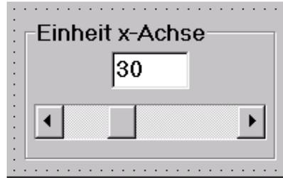
Der Wert einer Scrollbar-Komponenten kann sich standardmäßig zwischen den Werten 0 und 100 bewegen. (Das kann im Objektinspektor auch abgeändert werden.) Die momentane Position des Schiebereglers ist in seiner *Position*-Eigenschaft gespeichert. Aus deren Wert und dem Maximalwert kann dann leicht der gewünschte Wert abgeleitet werden. Soll sich z. B. eine Variable *x* mit Hilfe einer Scrollbar *Scrollx* zwischen den Werten 1 und 2,5 ändern, dann erhalten wir:
